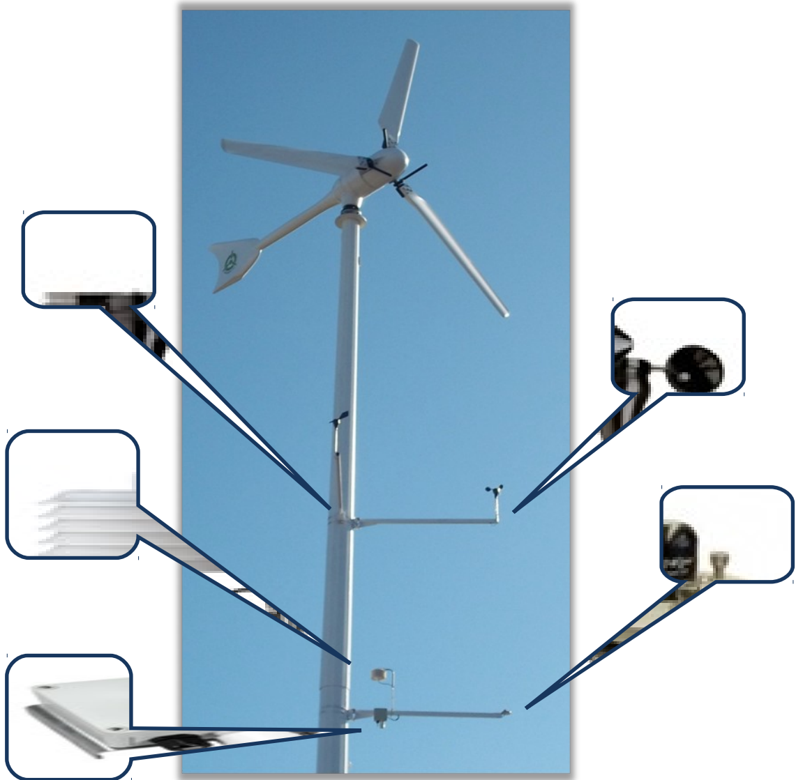
Figura 12. Posición de los sensores sobre la torre del aerogenerador.
